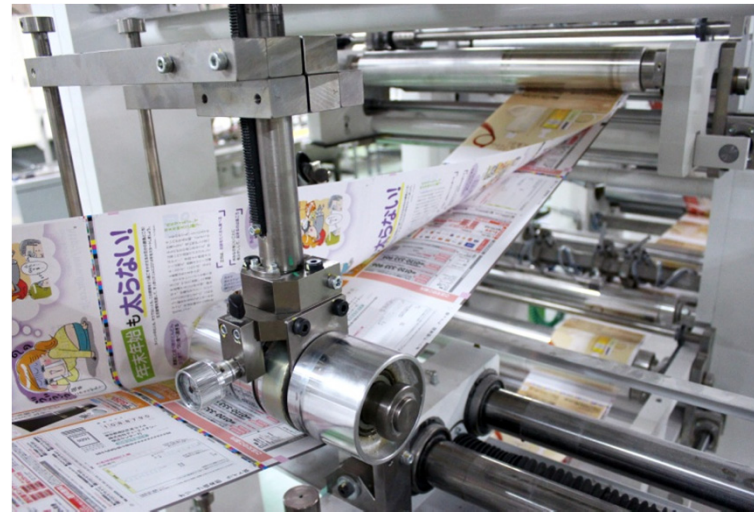
輪転機で印刷後、折り→断裁しインラインで表紙等 4 P を製造
