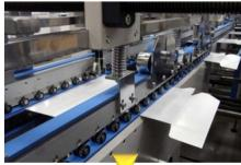
←折り・糊付け・組み立て を自動で行う サックマシン
