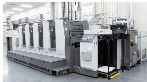
片面5色を印刷する新型のコンパクトなH-UV平台印刷機
