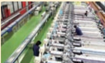
2008年2月に、最新型の中綴製本機を5台増設しました。毎時1万5千冊の高速製本を行うコルプスの無線綴製本機とラッピング機の稼働も始まり、印刷工場と連携した新しい生産ラインがスタートします。
