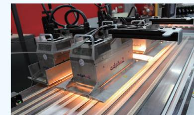
印字後瞬時にインキを乾燥させる乾燥部
