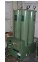
油水分離装置
